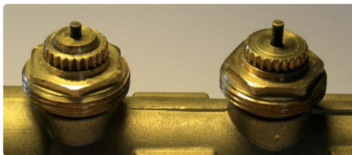
Två olika fördelarmodeller med styrdon. Till vänster RWG och till höger WGF, som säljs än idag.
